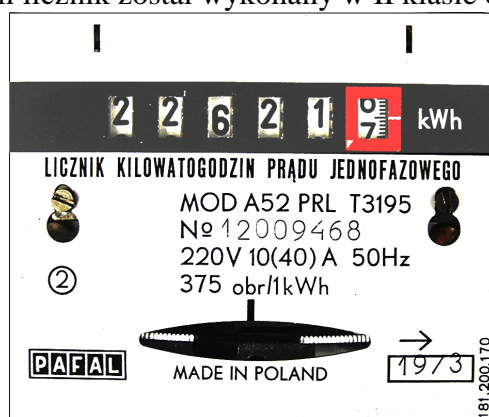
Rys.12. Przykładowa tabliczka znamionowa licznika energii elektrycznej
