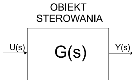
Rys. 1.2. Schemat blokowy jednowymiarowego obiektu sterowania
