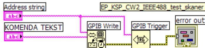
Rys. 13. Diagram programu sterującego komutatorem I201
