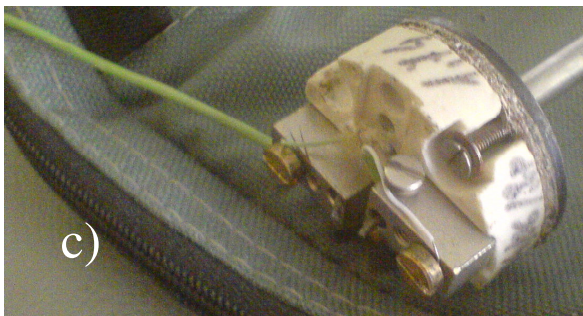
Fot. a – złącze do podłączenia termopar, b- termopara przemysłowa z wtyczką, c-zbliżenie złącza termopary
